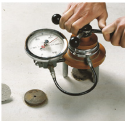
Badanie wytrzymałości powierzchniowej na rozciąganie, tzw. „pull off”
