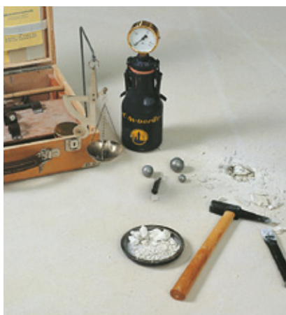
Urządzenie CM służące do badania wilgotności resztkowej
